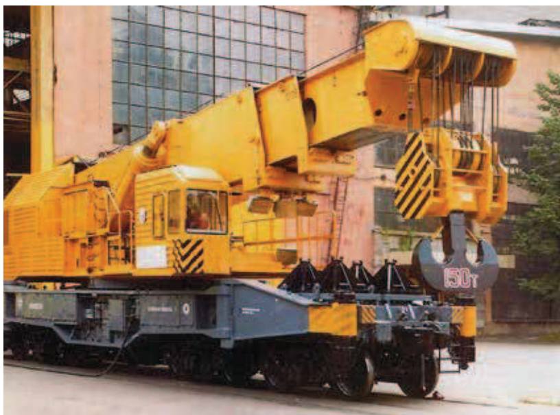
Рис. 7. 150-тонный самоходный железнодорожный кран
