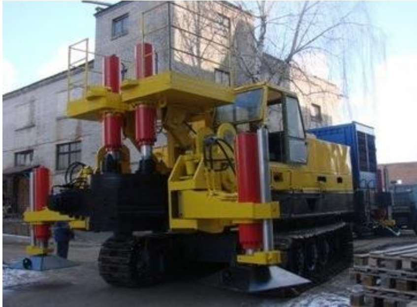
Сваевдавливающая установка СУПС-В
