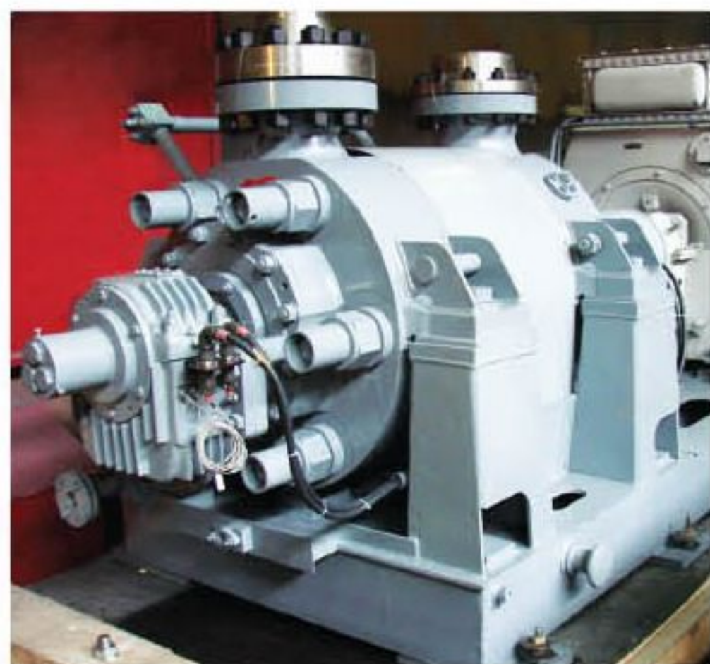
Циркуляционный электронасосный агрегат АЦНА 250-75 для АЭС.
